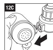
Substitua-o por um novo filtro, repetindo as operações conforme descrito no ponto 7 do parágrafo "PREPARAÇÃO DO SISTEMA FILTRANTE", "ATIVAÇÃO DO INDICADOR MANUAL DE DURAÇÃO DO FILTRO" e "UTILIZAÇÃO DO SISTEMA FILTRANTE - Ativação do filtro HYDROSMART™ METAL STOP".
